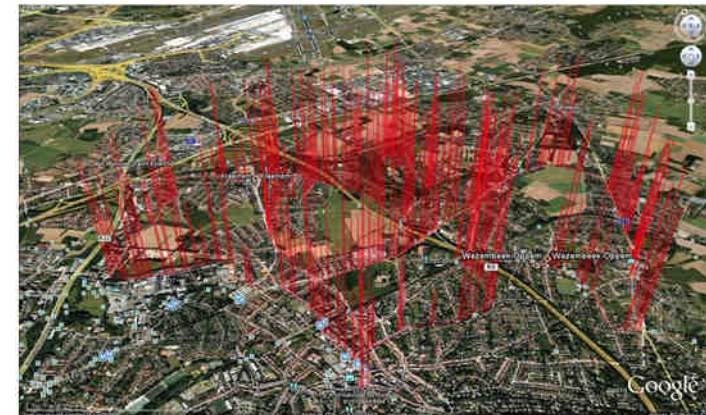
> 30 Lux lamps in an EN-13201 « 15 lux » area
